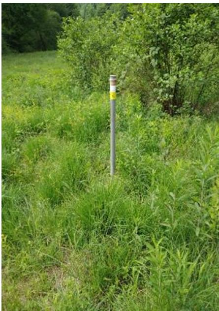
Slika 3: Izveden piezoemeter
